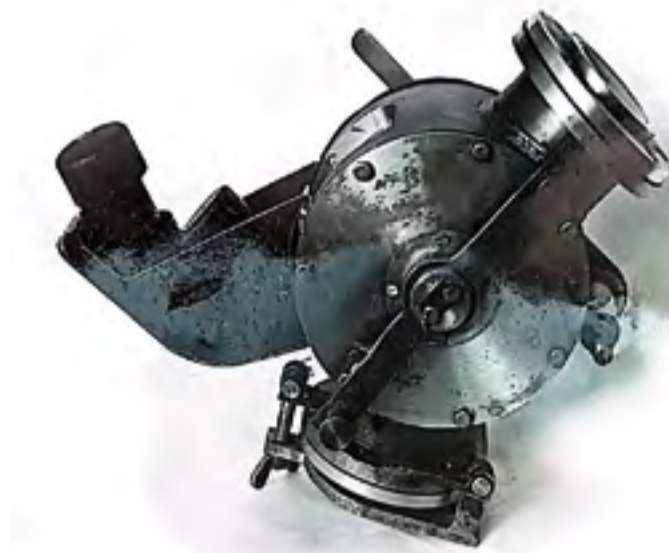
Малогабаритная приемно-отправительная станция для капсул пневмопочты. 1971 г. РГА в г. Самаре
