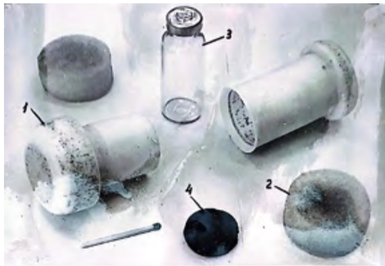
Капсула для отправки химических проб. 1971 г. РГА в г. Самаре
